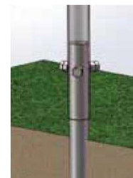
4. Fije el poste y el tornillo de tierra con pernos
