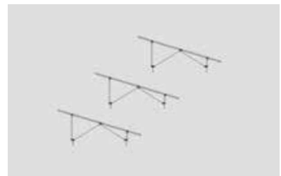
Fijar las picas al suelo y las piezas pre-montadas
